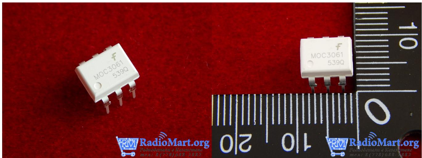
МОС3061М, Оптопара с симисторным выходом 600В, переключение при переходе через ноль [DIP-6]
