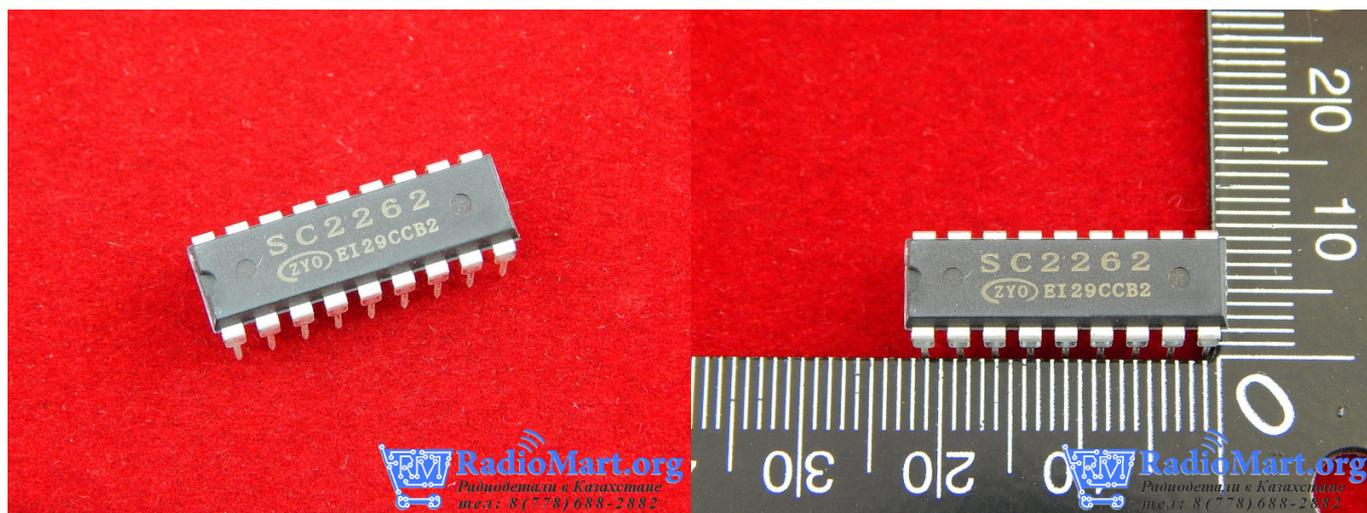
SC2262 Микросхема шифратор - предназначенная для передачи сигналов управления на микросхему SC2272.
