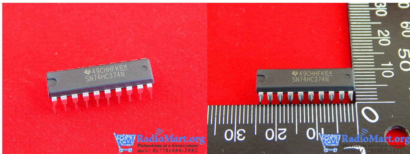
SN74HC374N, 8-битный, 8-канальный D-триггер со срабатыванием по положительному фронту, три состояния
