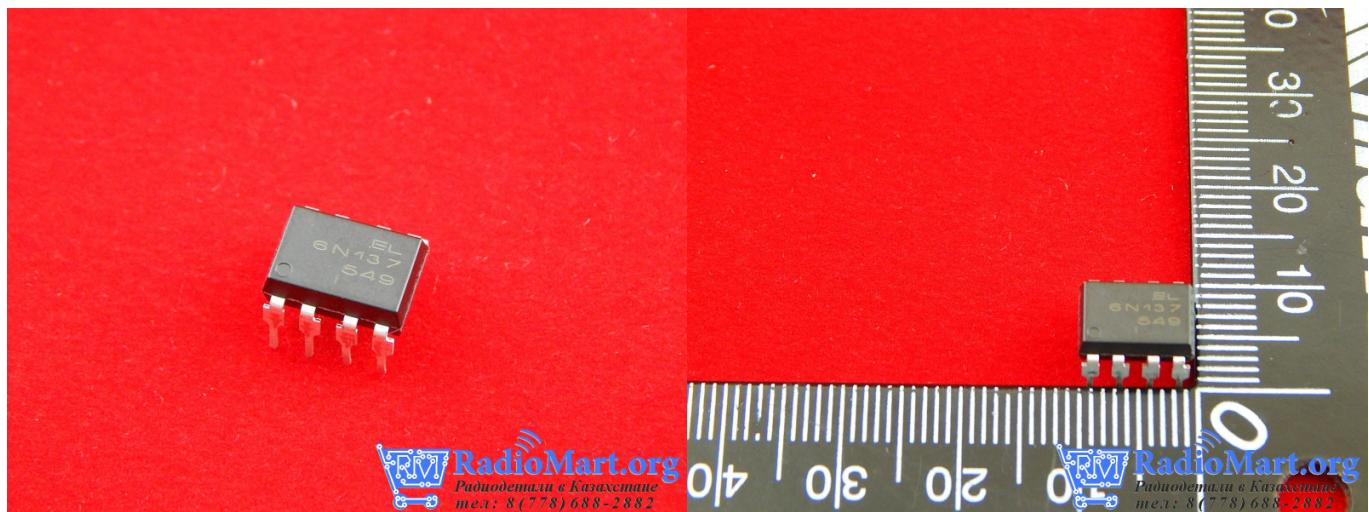
EL6N137 - Оптопара высокоскоростная 10 Мбит. С логическими уровнями на выходе
