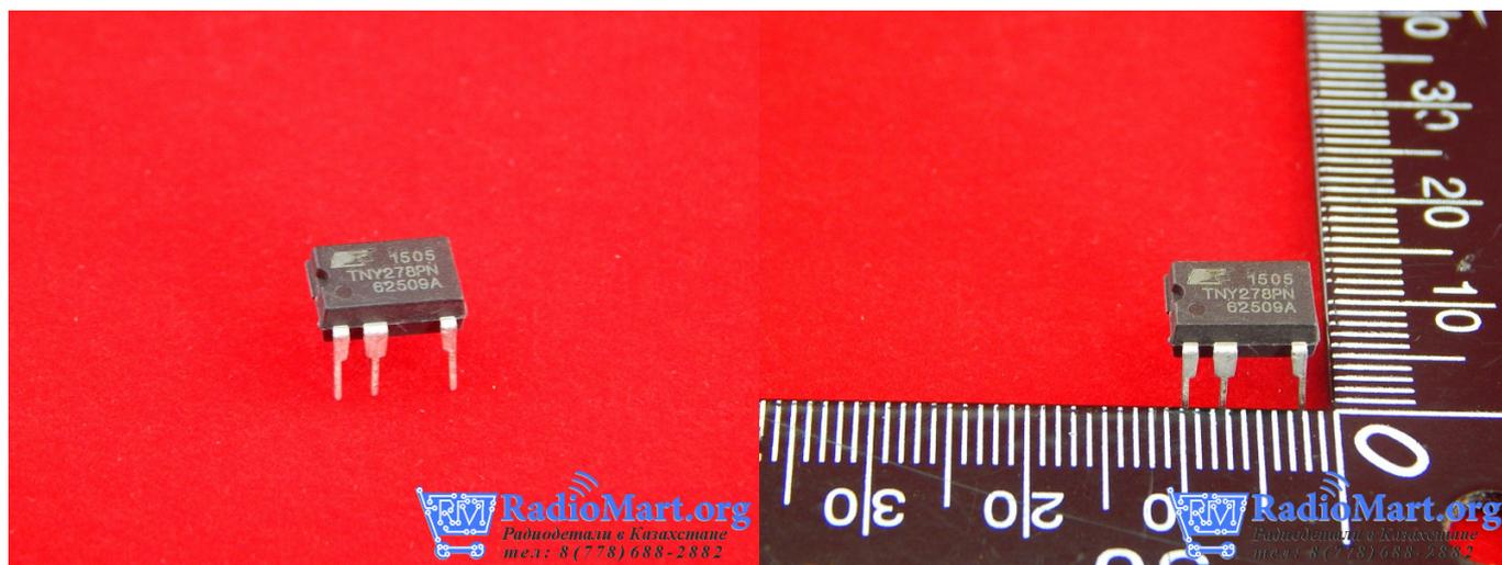
TNY278PN, SMPS схема управления, 16-28Вт
