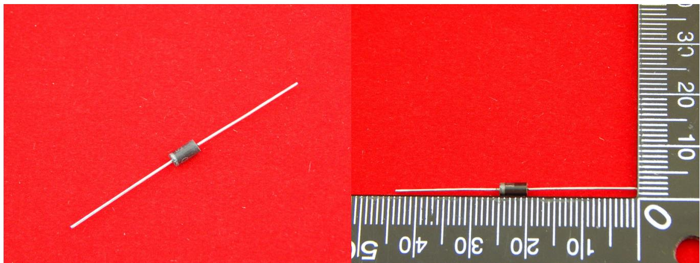
Диод выпрямительный с быстрым восстановлением аксиально-свинцового типа. Применяется в источниках питания постоянного тока, инверторах, преобразователях, ультразвуковых системах и измельчителях. Полное время восстановления диода ~150 наносекунд, обеспечивающее высокую эффективность при частоты до 250 кГц.
