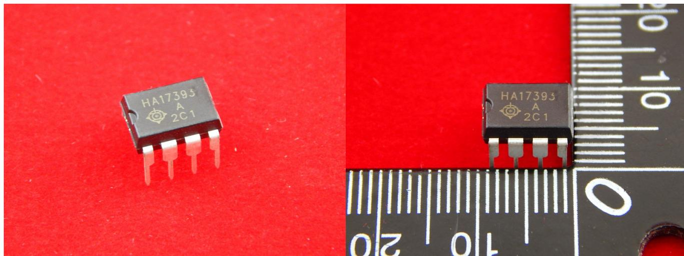
Компаратор — электронная схема, принимающая на свои входы два аналоговых сигнала и выдающая логическую «1», если сигнал на прямом входе больше, чем на инверсном входе, и логический «0», если сигнал на прямом входе меньше, чем на инверсном входе.
