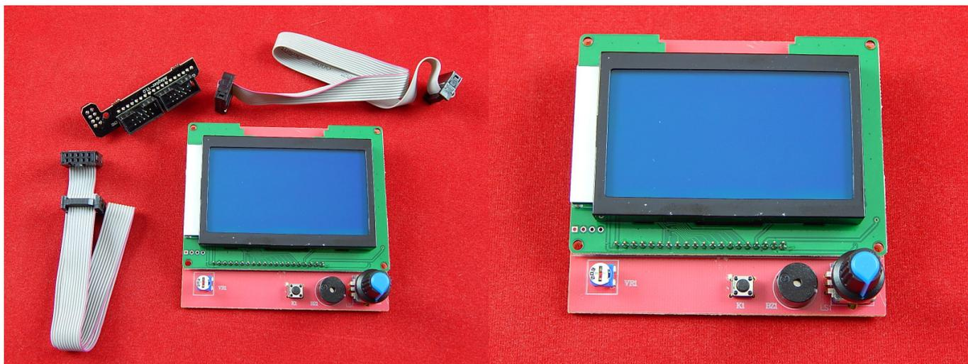
При подключении этого модуля к плате RAMPS 1.4 вы сможете менять настройки и следить за процессом печати без подключения компьютера.
