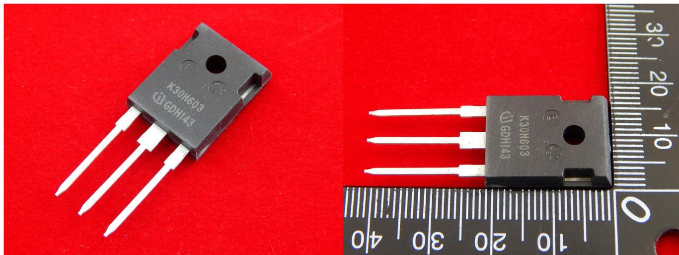
К30Н603 (=IKW30N60H3) Биполярный транзистор с изолированным затвором IGBT - полностью управляемый полупроводниковый прибор, в основе которого трёхслойная структура. Его включение и выключение осуществляются подачей и снятием положительного напряжения между затвором и истоком
