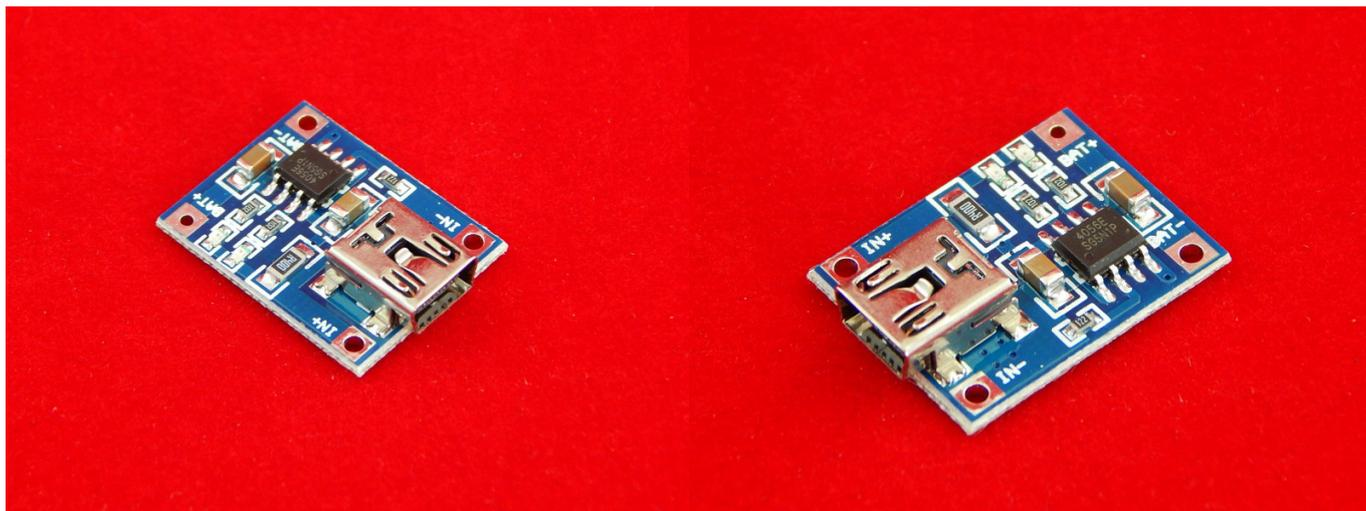
Зарядное устройство для литиевых и литиево-полимерных батарей TP4056 1А, напряжение полной зарядки 4.2В, вход mini USB 4.5 - 5.5В.
