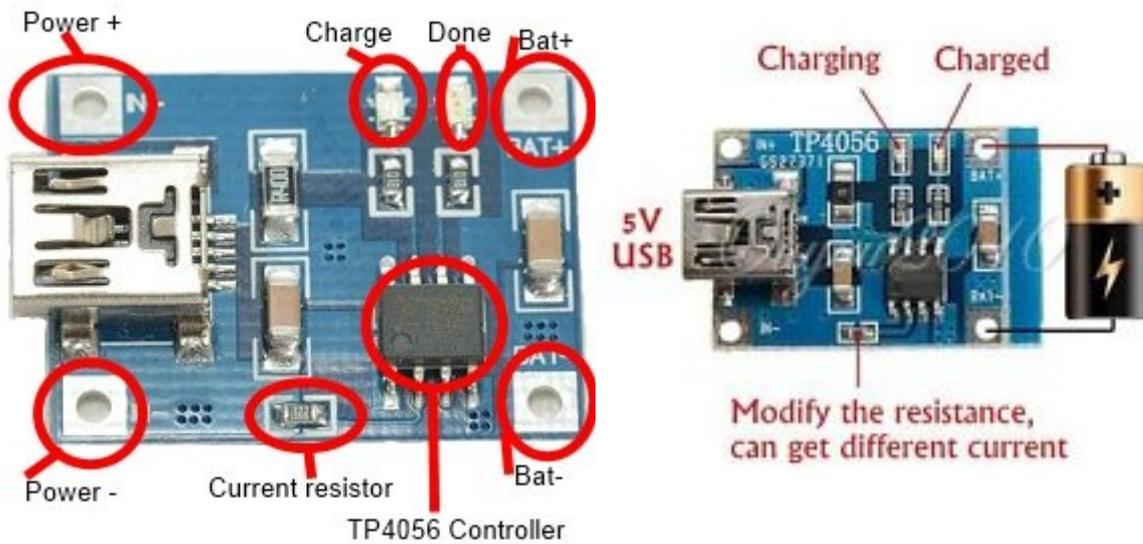
Ток заряда зависит от номинала резистора Rprog на 2 ножке микросхемы.
