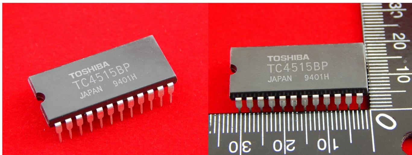
TC4515BP - Дешифратор Линии 4-Bit Прозрачный Latch/4-to-16
