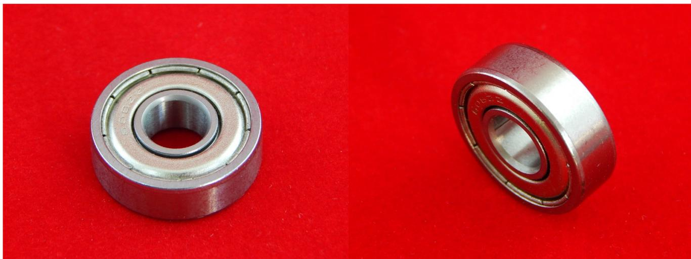
608 подшипник является подшипником качения. Его внутренний диаметр 8 мм, а внешний 22 мм. Ширина подшипника 7 мм
