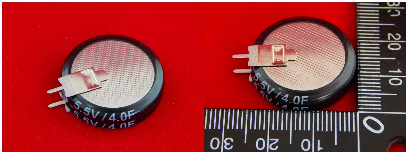
Ионисторы (Суперконденсаторы) - электрохимические приборы, предназначенные для хранения электрической энергии. Они характеризуются большим числом циклов заряда/разряда, длительным сроком службы, большой плотностью энергии.
