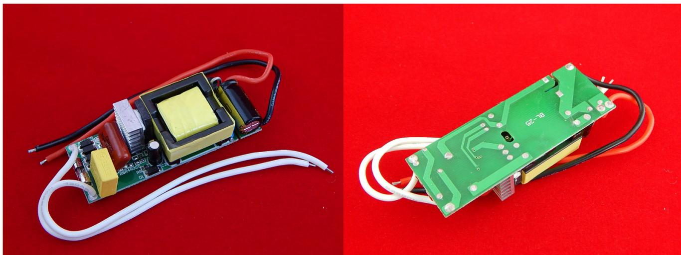
Преобразователь напряжения 220 вольт на 35 Вольт для подключения 30 Вт светодиодов
