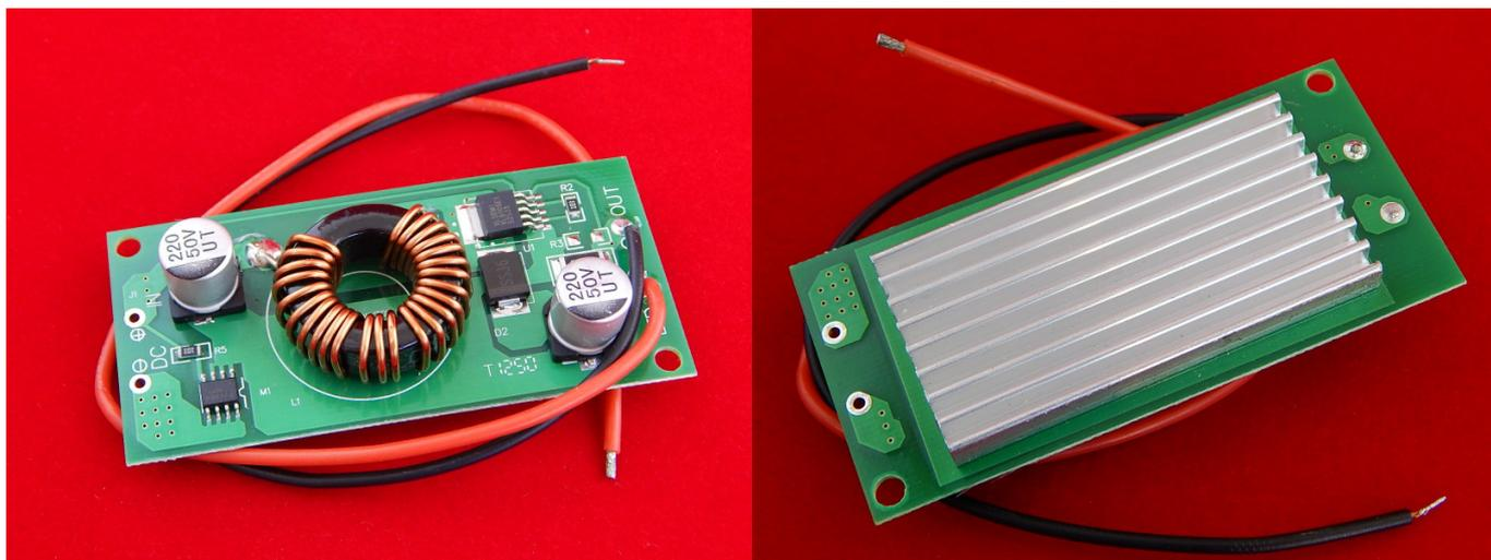
Автомобильный преобразователь напряжения с бортовых 12 вольт на 35 Вольт для подключения 30 Вт светодиодов
