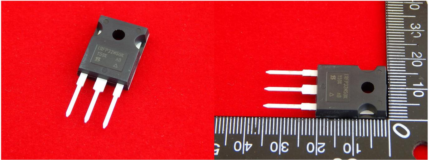
IRFP32N50 Транзистор. Корпус: TO-247AC, инфо: MOSFET N-канал 500V/ 32A/460Вт/0.135 Ом
