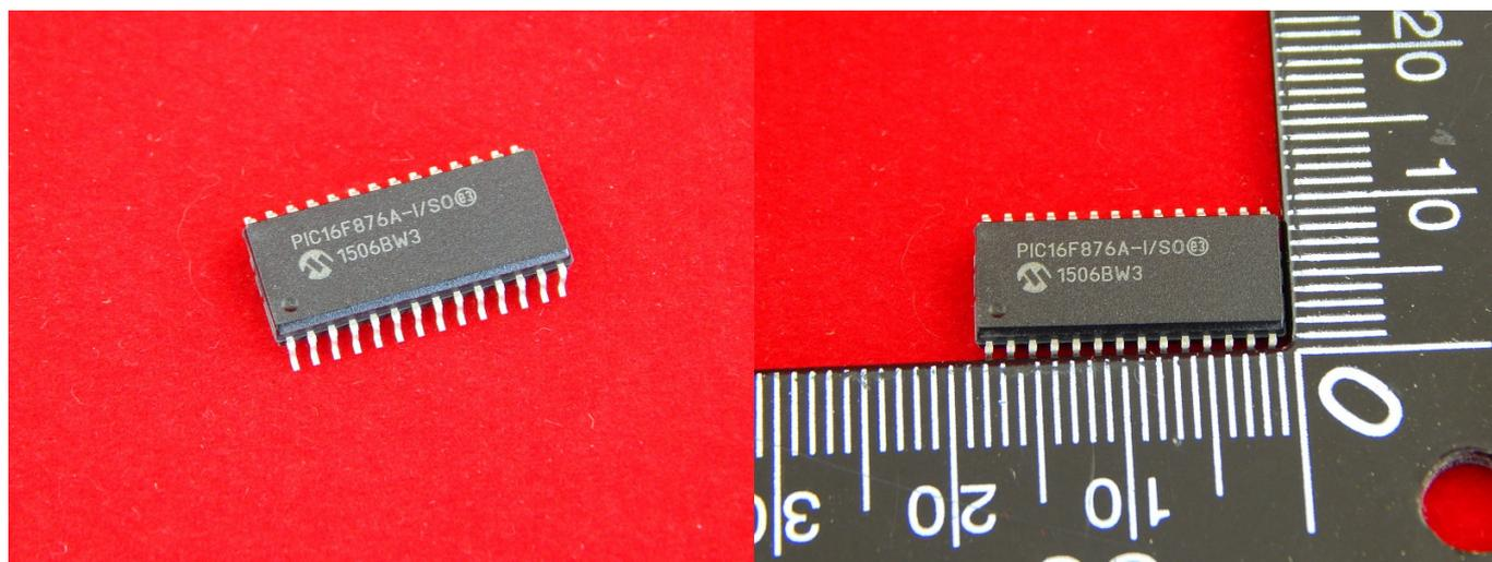
PIC16F876A-I/SO 8-битный микроконтроллер в SOIC-28 корпусе
