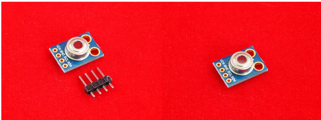
ИК датчик температуры GY-906 MLX90614ESF предназначен для бесконтактного измерения температуры в диапазоне от -70 до +380 °С. Датчик также позволяет измерять температуру окружающей среды.
