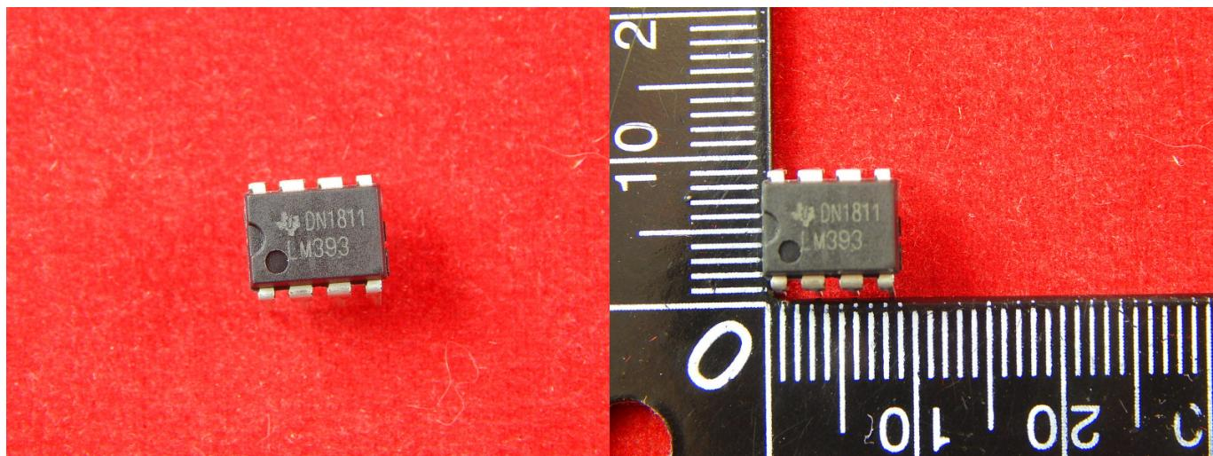
Электронная схема, принимающая на свои входы два аналоговых сигнала и выдающая логическую «1», если сигнал на прямом входе («+») больше, чем на инверсном входе («-»), и логический «0», если сигнал на прямом входе меньше, чем на инверсном входе.
