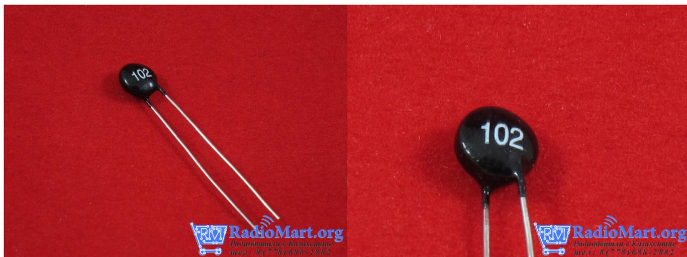
Термистор изменяет свое сопротивление в зависимости от температуры окружающей среды. Изготавливают терморезисторы из различных материалов, температурный коэффициент сопротивления (ТКС) которых достаточно высок. Значительно превосходит металлические сплавы и чистые металлы.
