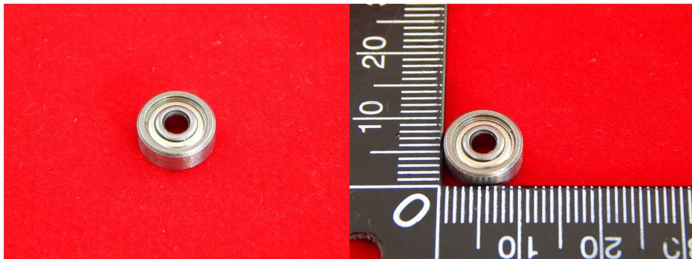
623ZZ подшипник для миниатюрных моделей. Его внутренний диаметр 3 мм, а внешний 10 мм.
