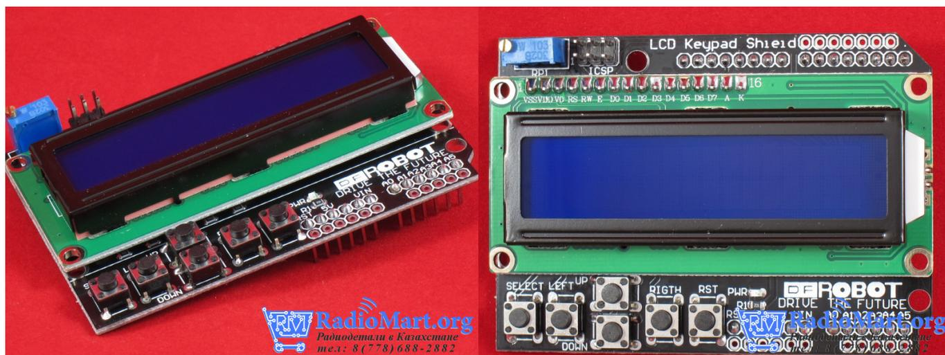
В состав платы входит LCD дисплей и 6 кнопок. Пины 4, 5, 6, 7, 8, 9 и 10 задействованы для управления LCD. На аналоговый пин 0 считываются сигналы с кнопок.
