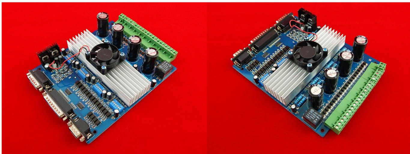
Контроллер шагового двигателя на 4 оси ТВ6560 на 3А с LPT интерфейсом.
