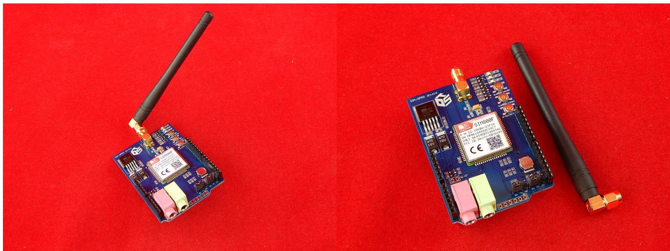
GPRS/GSM Модуль предоставляет вам возможность использовать функции мобильного телефона в сети GSM для приема данных из удаленного местоположения. Модуль позволяет добиться этого с помощью любых из трех способов: Служба передачи коротких сообщений (СМС), Аудио, GPRS служба.
