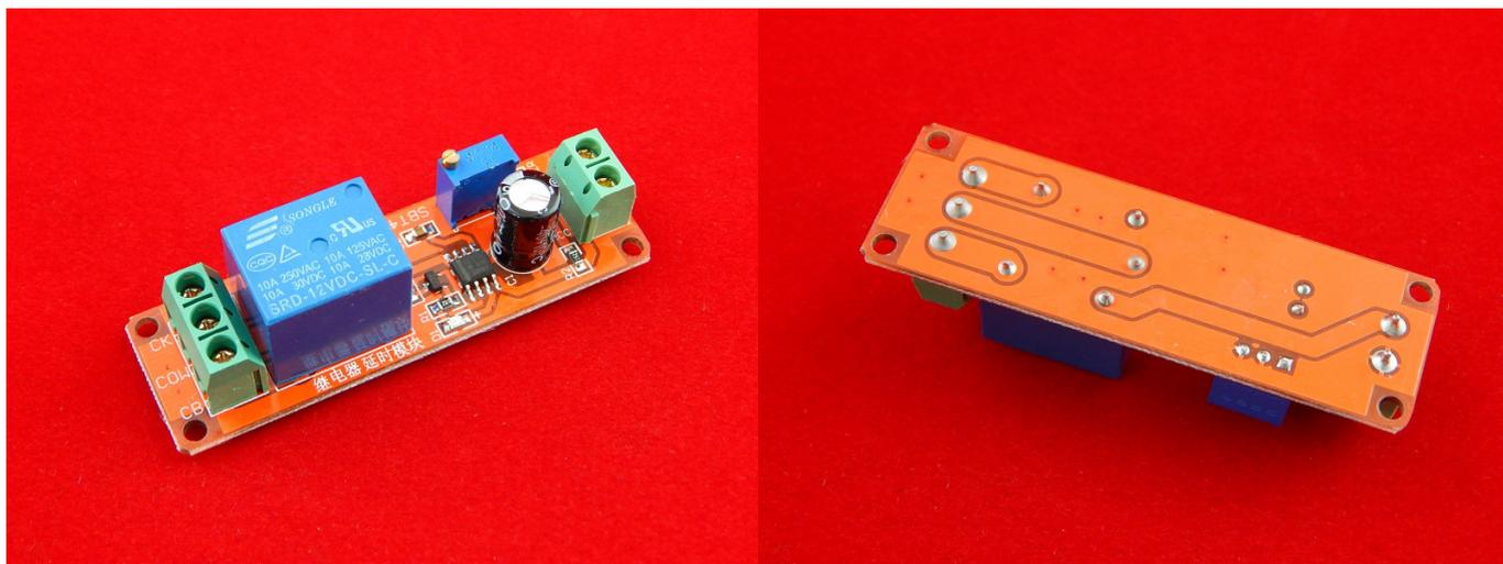
При подаче напряжения 12 вольт на вход срабатывание реле происходит не сразу, а с задержкой 1-10 секунд (регулируется подстроечным резистором).
