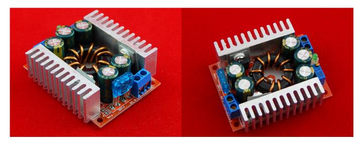
Понижающий конвертер является преобразователем постоянного тока, на базе которого можно построить источник питания с требуемым напряжением
