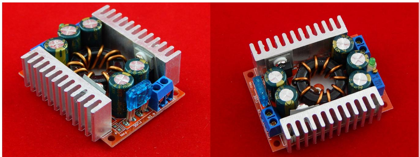
Понижающий конвертер является преобразователем постоянного тока, на базе которого можно построить источник питания с требуемым напряжением
