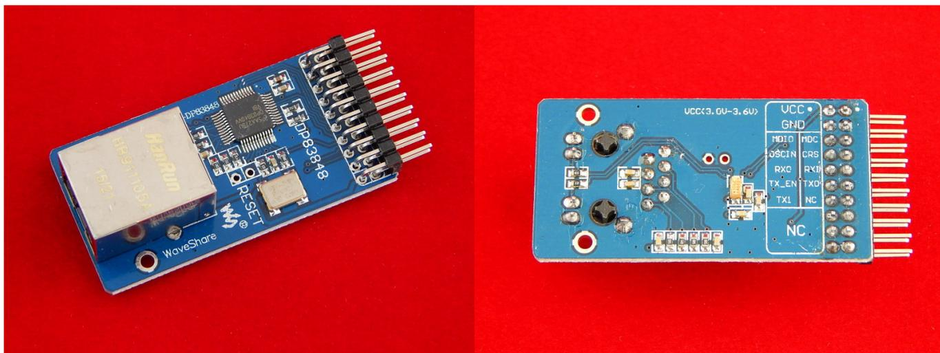
DP83848 Ethernet Board - макетная плата с установленным Ethernet трансивером физического уровня DP83848, разъемом RJ-45 и управляющим интерфейсом.
