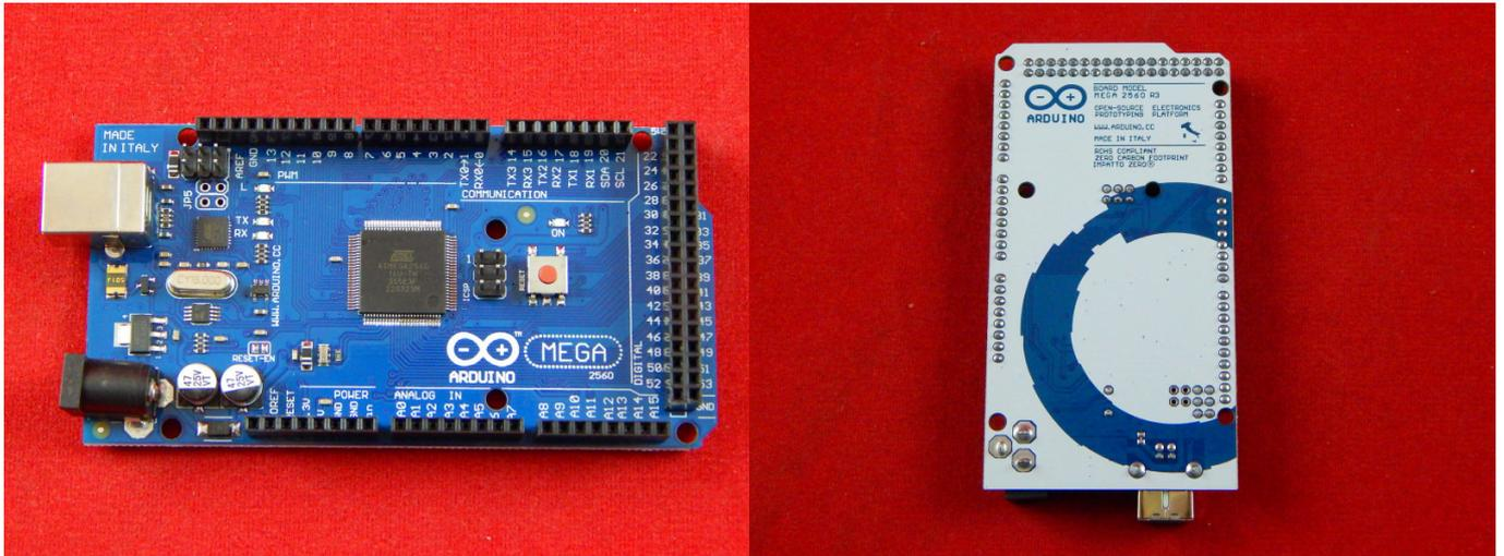
Меха 2560 — это расширенная версия Arduino Uno. Платформа выполнена на базе более продвинутого чипа ATmega2560, имеет больше контактов и большее количество аппаратных serial-портов для взаимодействия с компьютером и другими устройствами. Это самая последняя модель: Mega 2560 Rev3, пришедшая на смену предыдущим Mega 2560 и Mega 1280.
