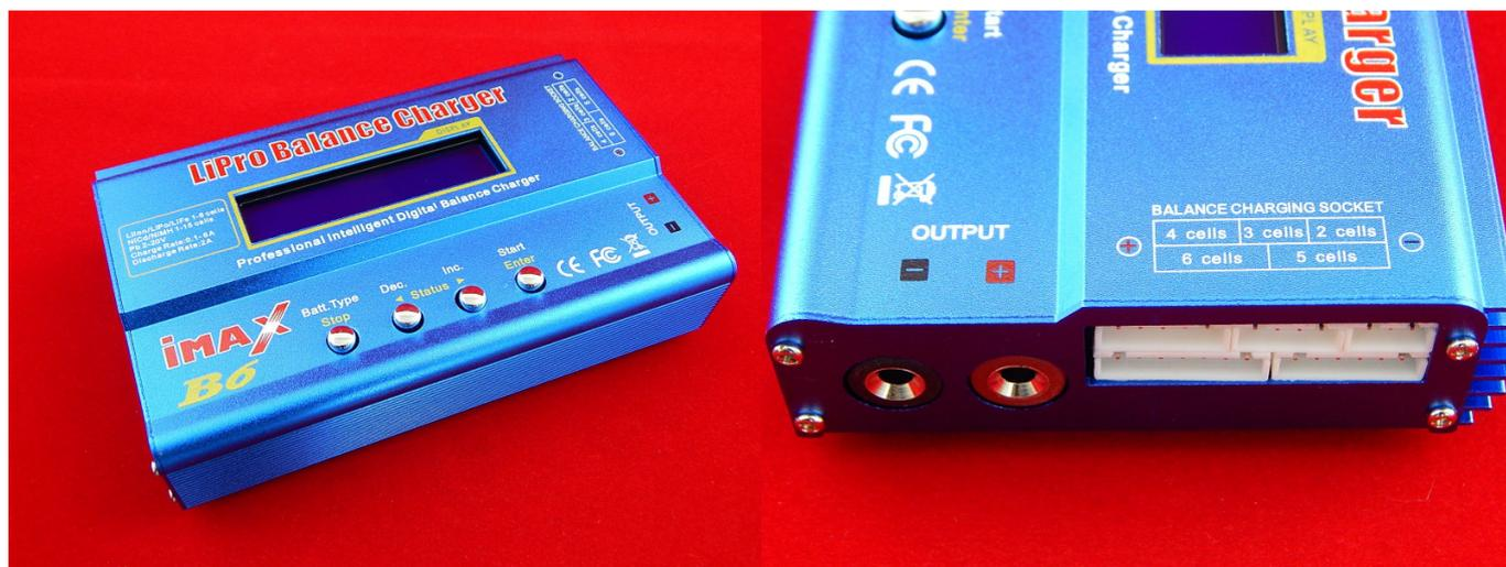
Многофункциональное зарядное устройство IMAX b6 со встроенным микропроцессором и дисплеем управления с помощью которого в любой момент процесса вы можете наблюдать за состоянием вашего аккумулятора и самого IMAX B6.
