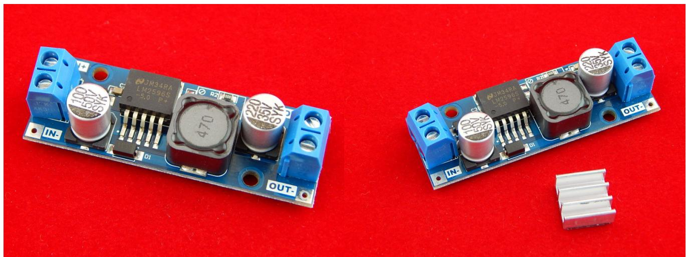
Модуль на LM2596 понижает входное напряжение (6.5-40В) до 5В, максимальный ток 3А.
