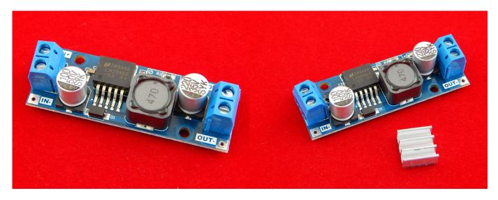
Модуль на LM2596 понижает входное напряжение (6.5-40В) до 5В, максимальный ток 3А.
