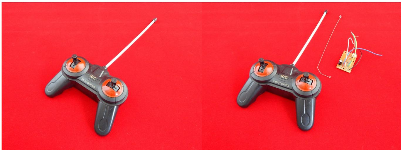
Двухканальный пульт дистанционного управления с приемником. Подойдет для управления моделью
