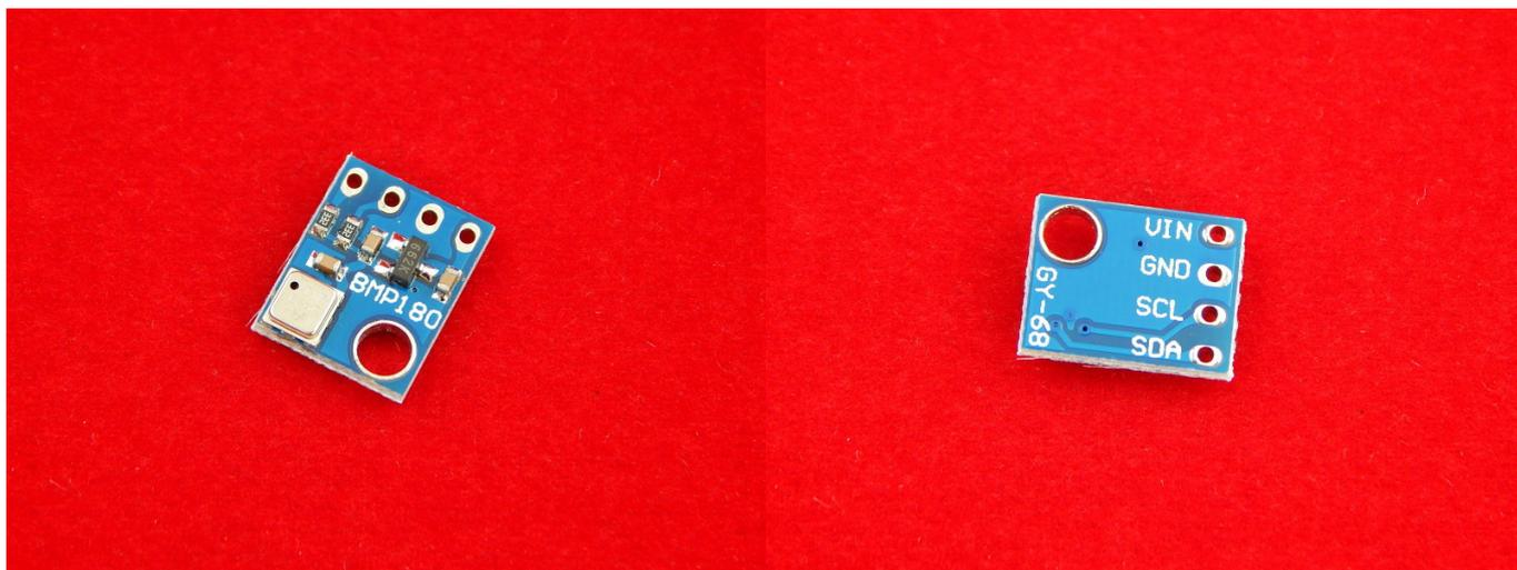
Датчик позволяет измерять абсолютное атмосферное давление в диапазоне 300...1100hPa (+9000...-500 метров над уровнем моря). С помощью преобразования абсолютного давления в высоту может использоваться как датчик высоты для вашего робота, мультикоптера, самолета.
