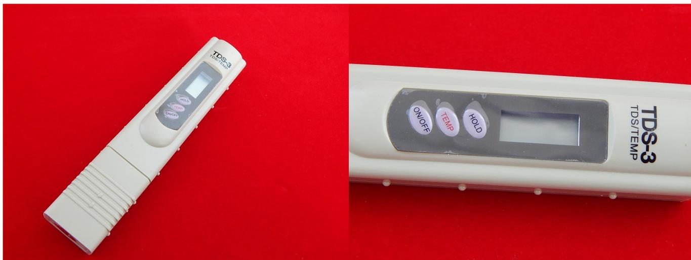
Переносной анализатор TDS-метр (солемер TDS-3) предназначен для измерения общего количества частиц (минерализация воды), растворенных в воде солей (TDS - total dissolved solids) на один миллион частиц воды — ppm (parts per million), а также и температуры воды. Кожаный чехол с клипсой на ремень входит в комплект поставки TDS измерителя.
