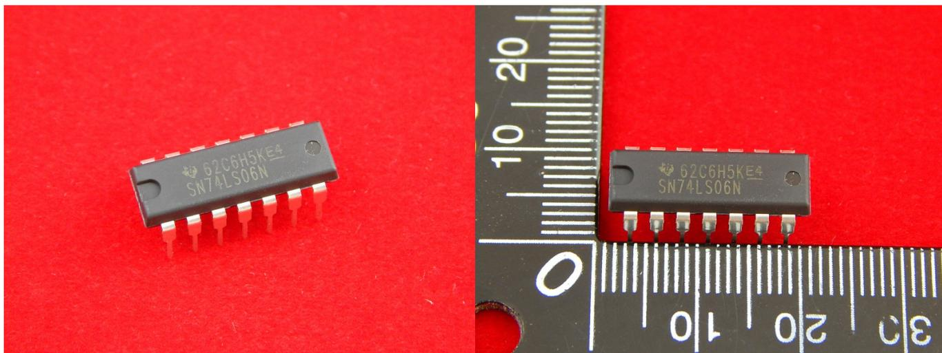
Микросхема SN74LS06N, в корпусе DIP16, Шесть буферных инверторов/драйверов с открытым коллекторным высоковольтным выходом
