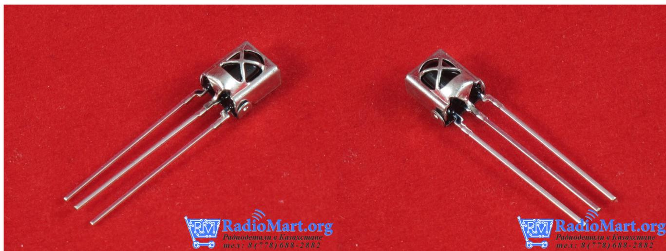
Инфракрасный (ИК, IR) приемник, работающий на частоте 38 кГц.
