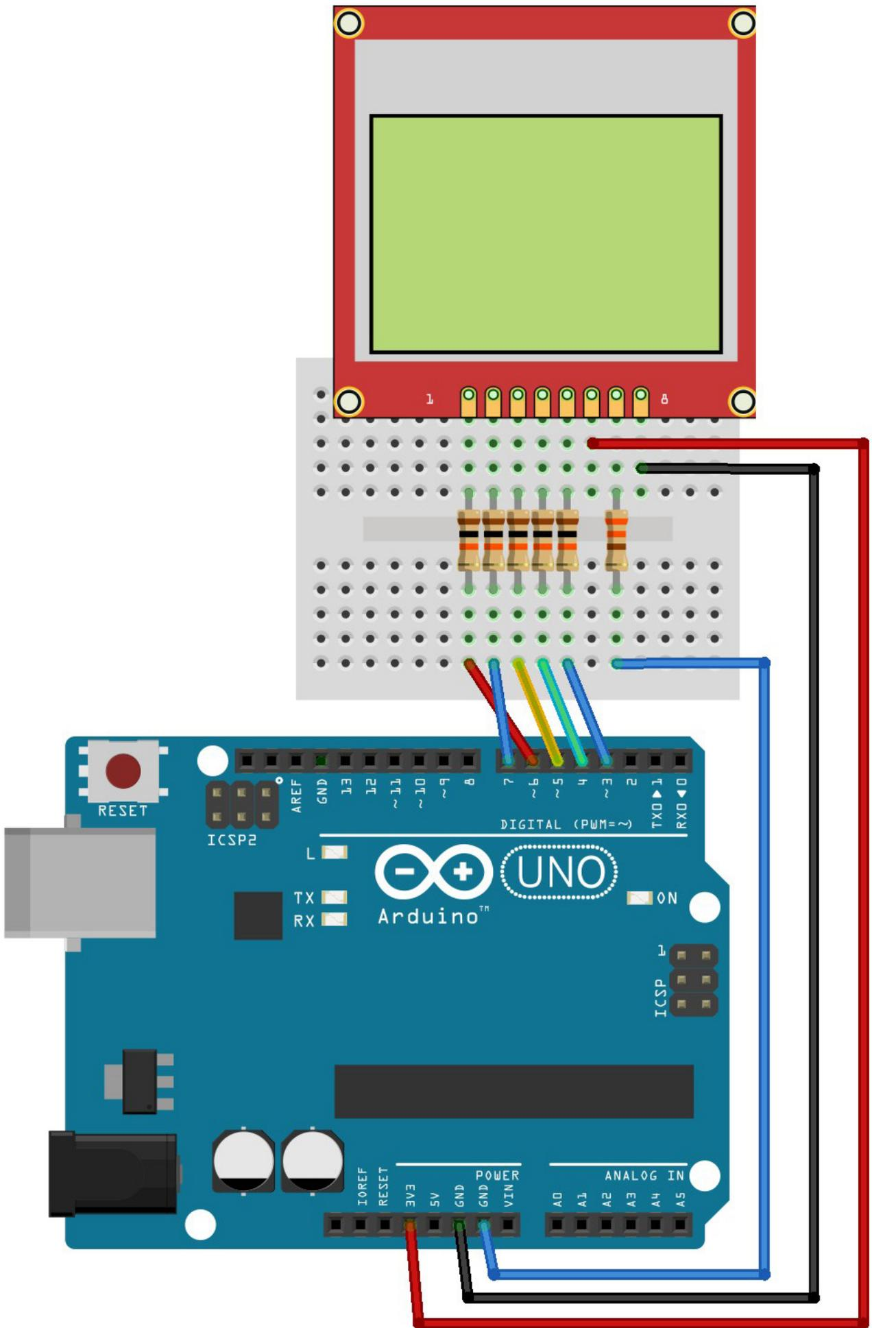
Соединение модуля Nokia 5110 LCD и Arduino UNO.
