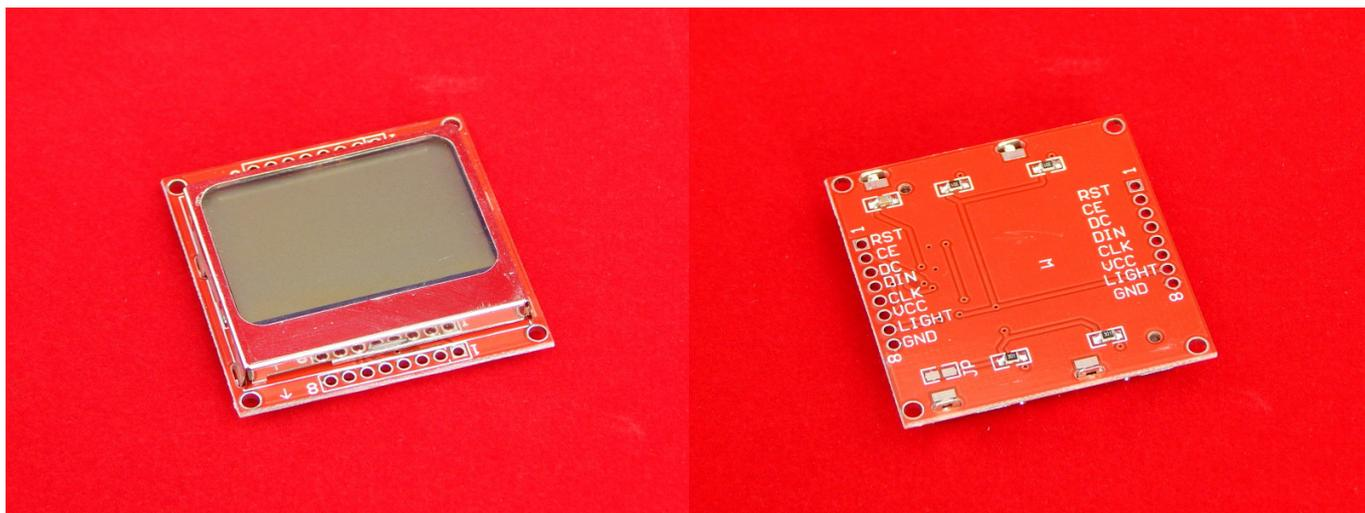
Монохроматический дисплей Nokia 5110 LCD (blue screen) имеет подсветку синими светодиодами. За годы производства Nokia 5110 применялся и применяется в широком спектре приложений. Модуль дисплея облегчает подключение Nokia и установку в приборе. Благодаря модулю упрощается первое знакомство электронщика, программиста с дисплеем Nokia 5110 LCD.
