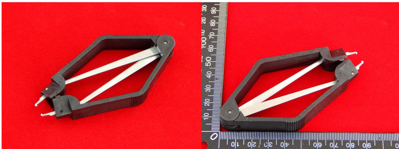
Данный инструмент предназначен для быстрого извлечения различных микросхем при демонтаже или ремонте устройств как в домашних условиях, так и в специализированных сервис-центрах. Конструкция экстрактора позволяет надёжно фиксировать и удерживать микросхемы и другие компоненты.
