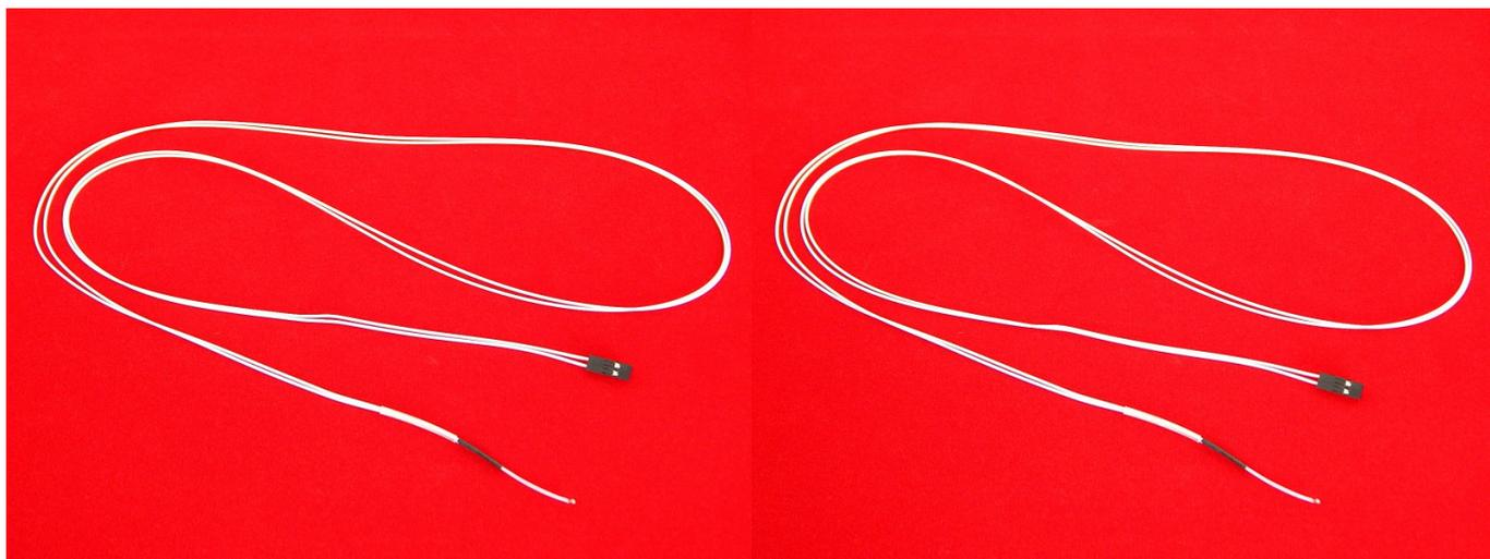
Датчик температуры для экструдера 3D принтера с кабелем 1м. Из-за очень большого изменения сопротивления датчик рекомендуется применять в задачах, в которых диапазон измерения не более чем 50-100 градусов (т.е., например, от 200°C до 280°C). Так же имеющий 2pin разъем для подключения к плате.
