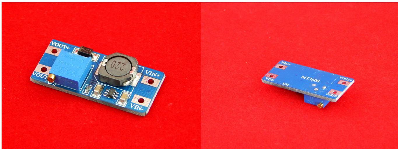
MT3608 - миниатюрный модуль повышающего преобразователя постоянного тока. Выходное напряжение на модуле MT3608 подстраивается триммером. Регулировка происходит подстроечным резистором. Удобен в проектах Arduino для подачи питания на устройства.
