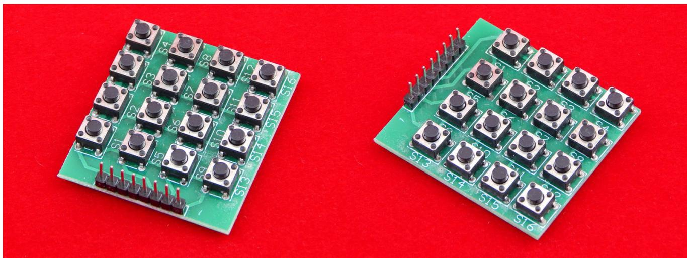
Модуль клавиатуры содержит 16 кнопок, имеющих контакты на замыкание. Предназначен для установки на переднюю панель прибора. Объединение в один модуль нескольких кнопок упрощает конструкцию передней панели прибора. Матричная 16-кнопочная клавиатура 4x4 найдет применение в кодовых замках, пультах дистанционного управления и в других приборах.
