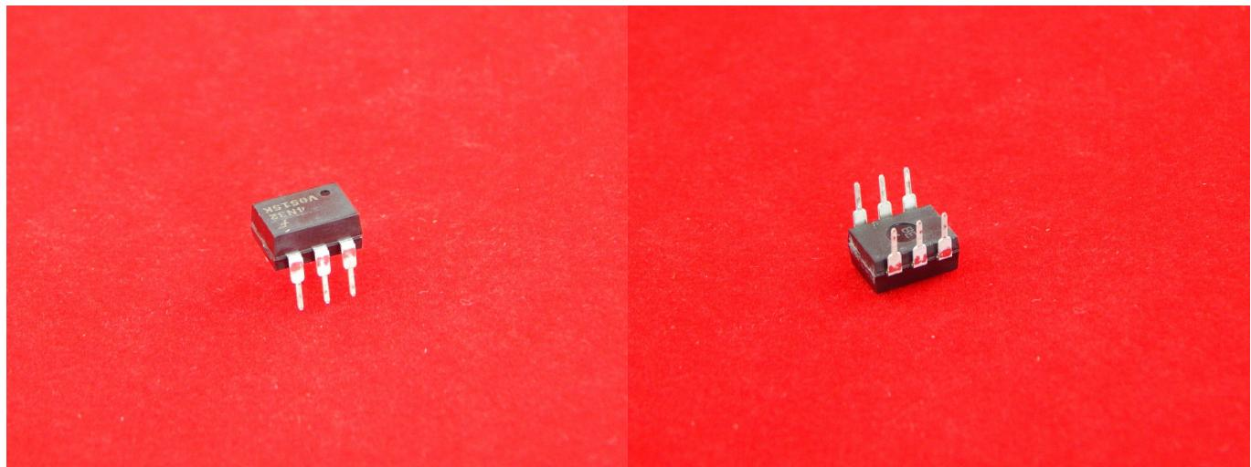
4N32 - Оптопара с транзисторным выходом (составной транзистор) [DIP-6]
