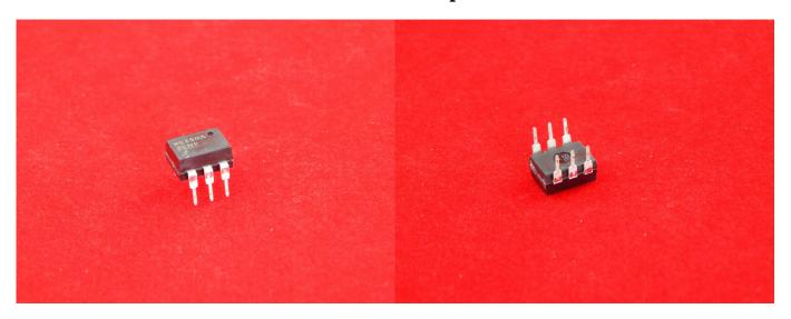
4N32 - Оптопара с транзисторным выходом (составной транзистор) [DIP-6]
