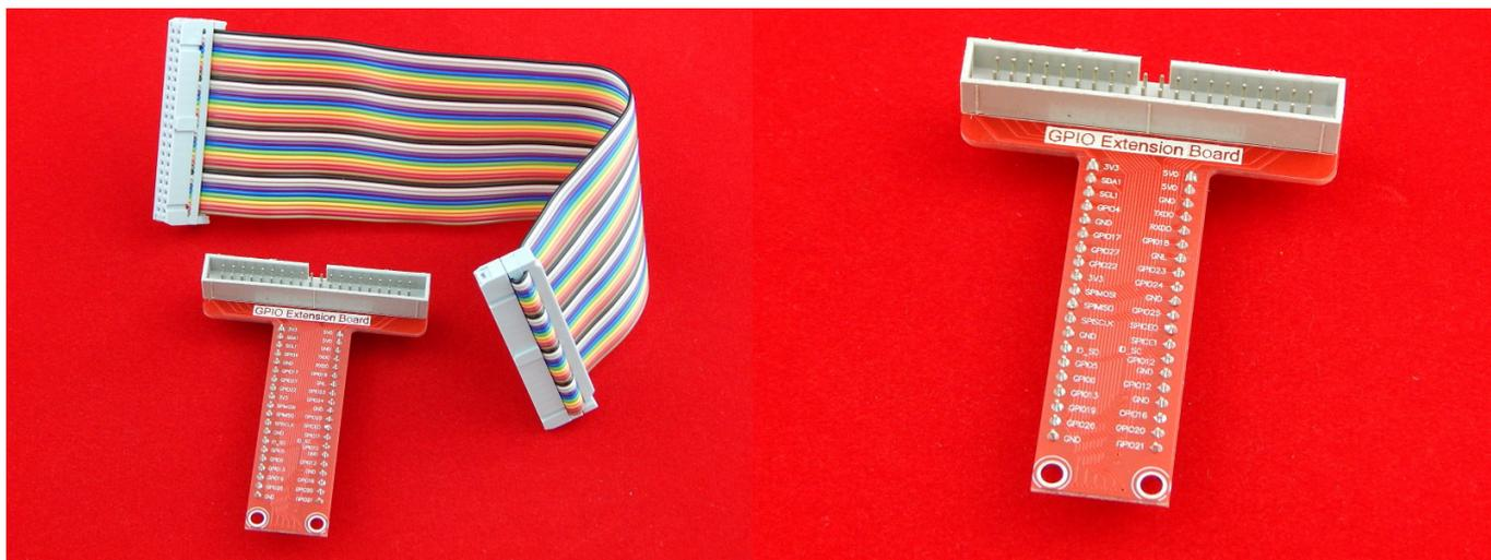
Переходник контактов с разъема шлейфа на Raspberry Pi для более удобной работы при использовании данных контактов.
