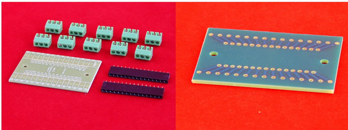
Плата расширения контактов для Xduino Nano, подключается как шилд и позволяет подключать контакты к зажимным клеммам что улучшает контакт и уменьшает дребезг контактов.
