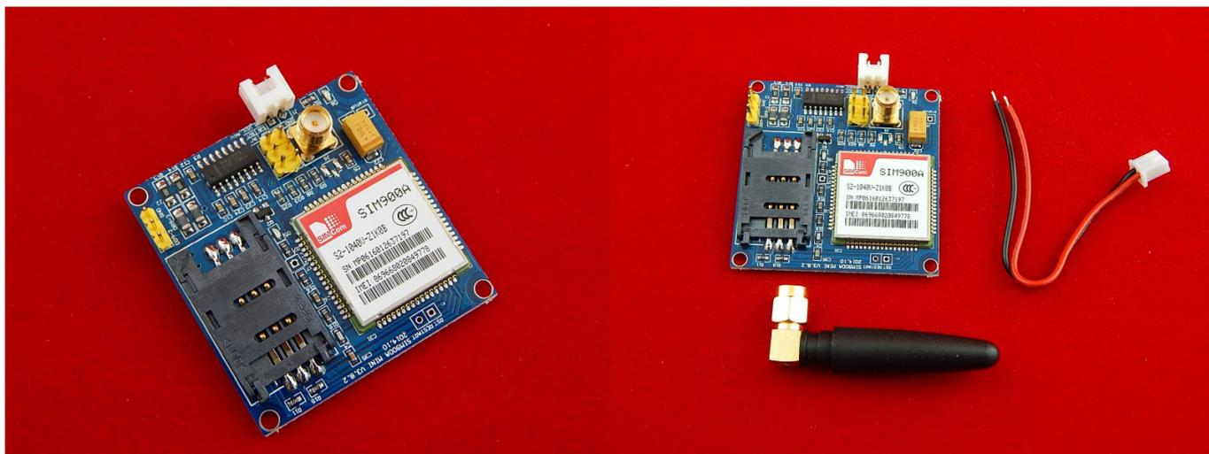
Модуль GSM/GPRS поддерживает все популярные способы связи: SMS/MMS, передача DTMF сигнала, GSM звонки, GPRS передача данных посредством TCP/IP. Размер платы 50x50x12мм что позволит вам уместить его в самые малогабаритные разработки.
