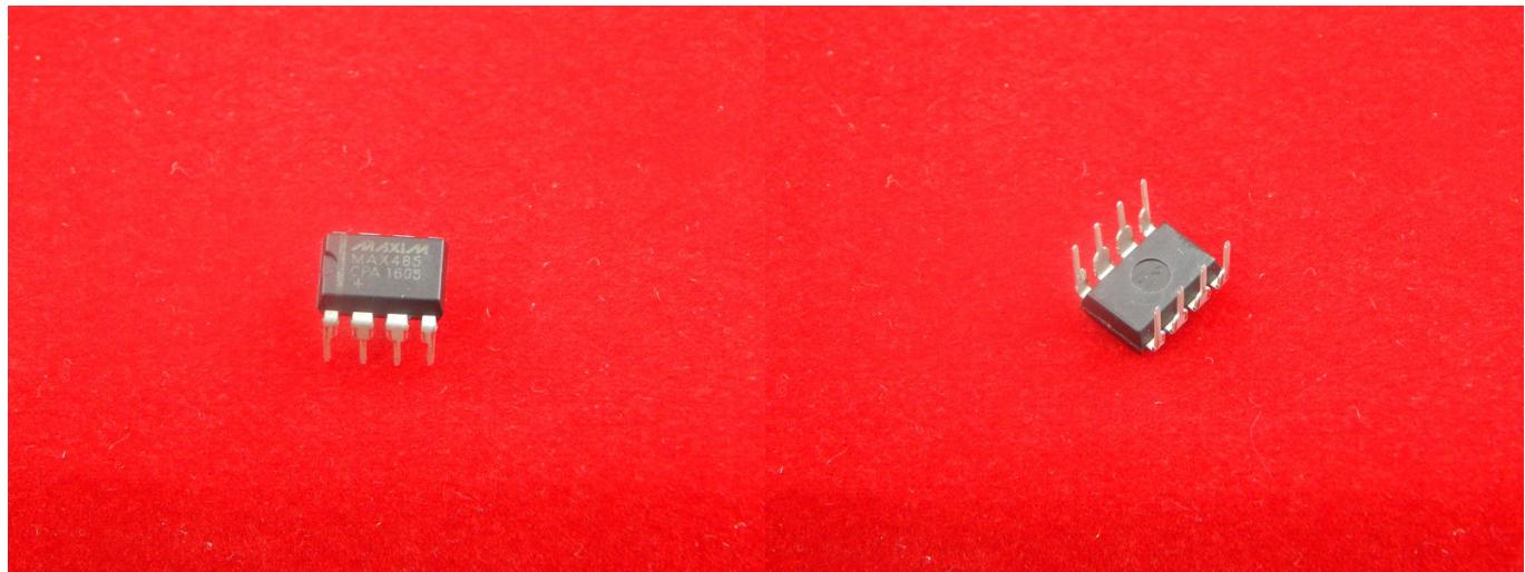
Микросхема MAX485 является маломощным трансивером, имеет приёмо-передающий тракт. Каждая часть микросхемы (max485) содержит один приёмник и один передатчик.
