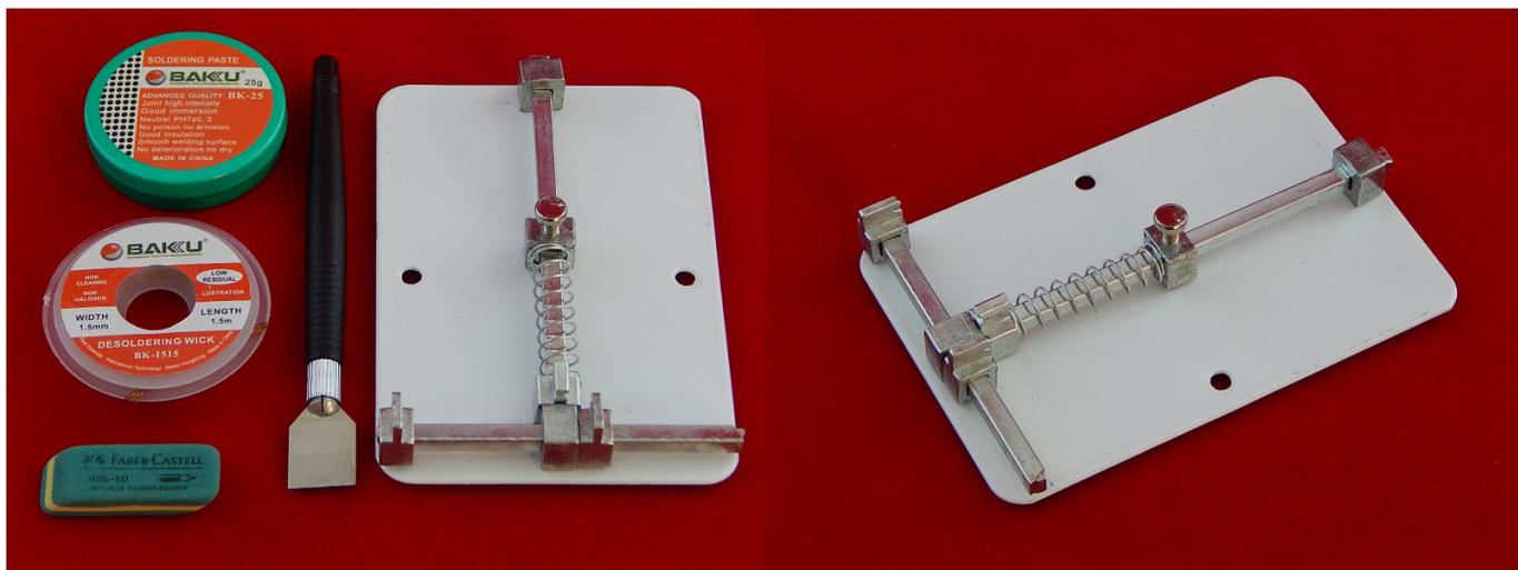
Держатель предназначен для закрепления плат и деталей для последующей работы с ними.
