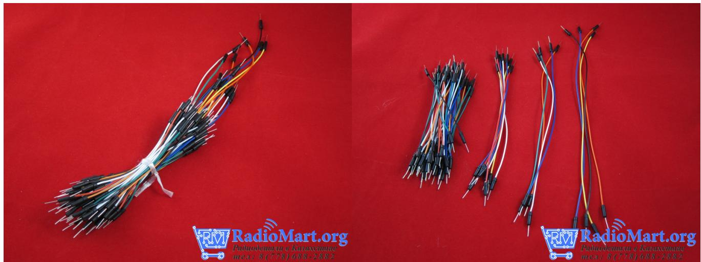
Макетные соединительные провода типа «папа - папа» позволяют выполнить быстро разъёмное соединение различных модулей и плат.
