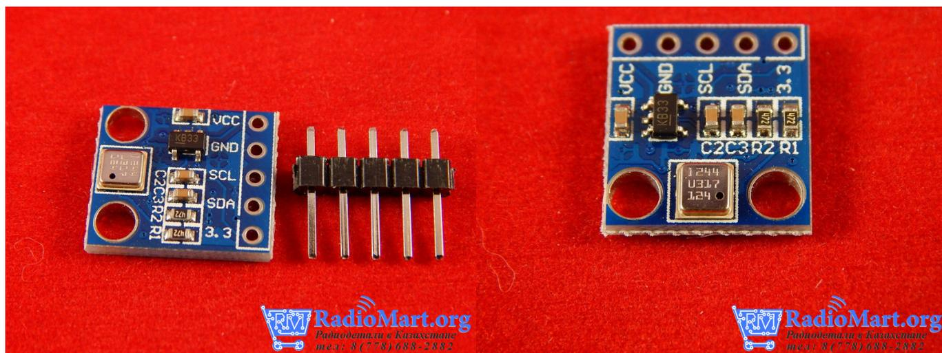
Датчик позволяет измерять абсолютное атмосферное давление в диапазоне 300...1100hPa (+9000....-500 метров над уровнем моря). Модуль можно использовать в домашних метеостанциях, летательных аппаратах, в качестве альтиметра и др. Также модуль может быть использован в комплекте с GPS модулем для уточнения высотных координат.
