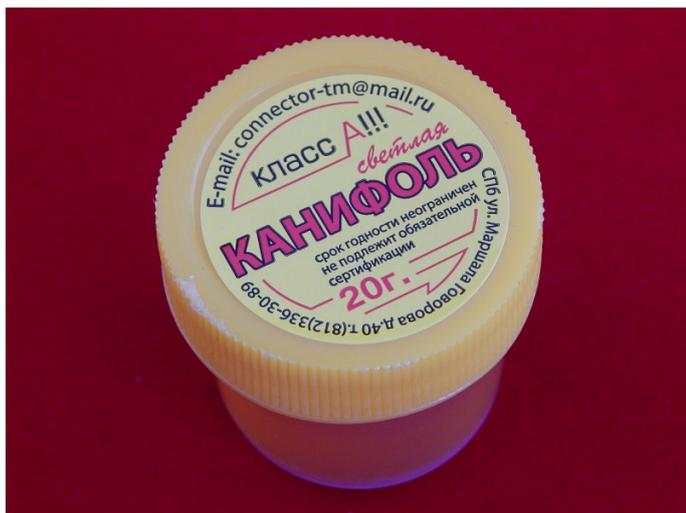
Канифоль сосновая, используется в качестве нейтрального флюса для высококачественной пайки и лужения деталей радио- и электротехнических устройств. Флюсы для пайки защищают от окисления поверхность нагреваемого металла и расплавленный припой, улучшая качество пайки.
