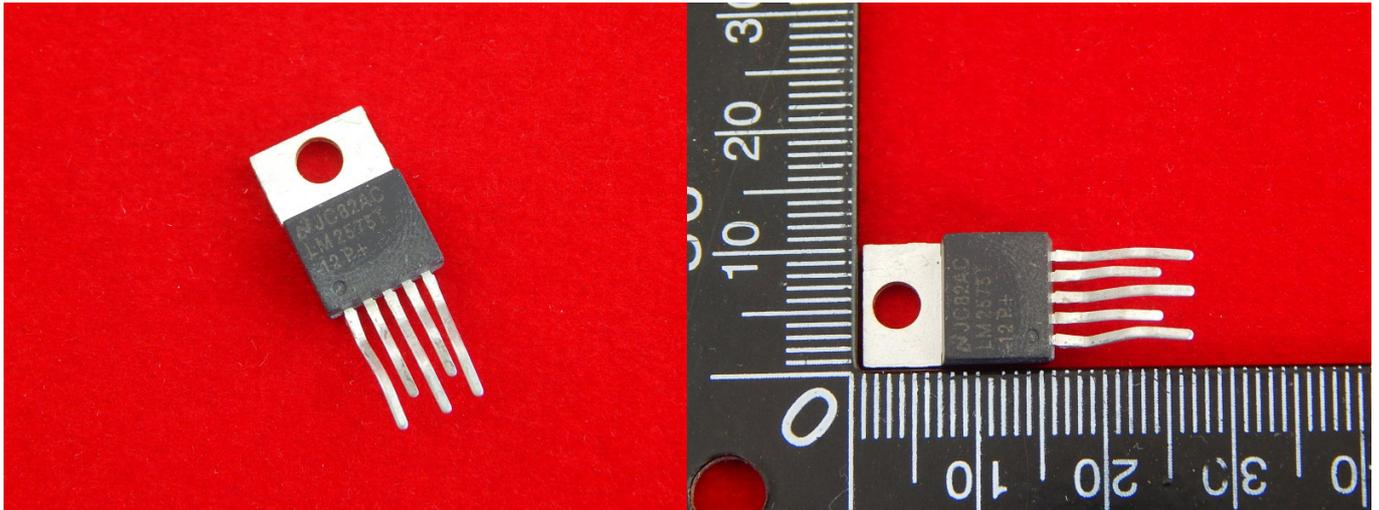
Импульсный понижающий регулятор напряжения LM2576T-12 3А, 12В.
